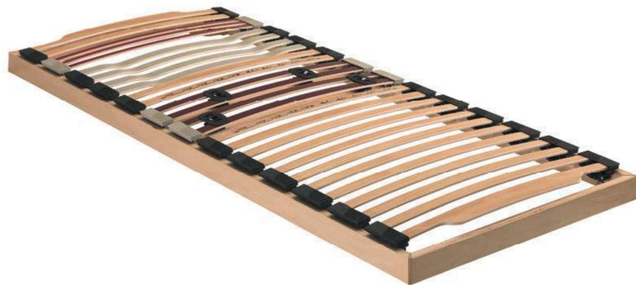
Rete a doghe con telaio e doghe in multistrato di faggio. I raccordi flessori aiutano nell'ammortizzare il peso del corpo e a regolare la resistenza delle doghe. Nella zona del bacino sono presenti dei cursori con regolabilità del peso e sono state inserite delle doppie doghe per dare maggiore sostegno.
